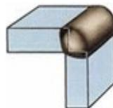
**Торцеве** зварне з'єднання двох елементів, в якому бічні поверхні зварених елементів примикають один до одного.
