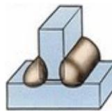
**Кутове** зварне з'єднання двох елементів, розташованих під кутом і зварених в місці примикання країв.
